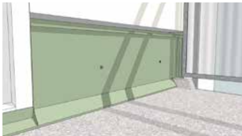
Skyddsbeslag vid balkong - sockelbeslag
