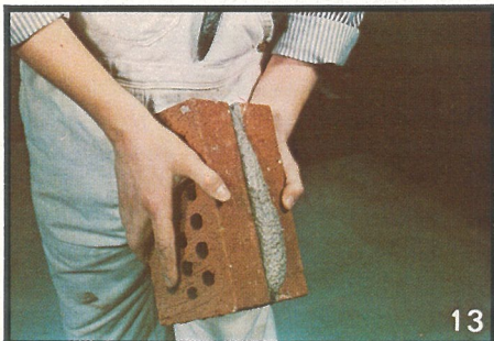
13) Vidhäftningen mellan tegel och bruk är väsentlig för att man skall få ett bra murverk. Den kan provas genom att två stenar muras samman.
