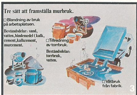
3) Bruk kan tillverkas på platsen genom blandning av ballast (stenmaterial), bindemedel (kalk, cement, kalkcement, murcement) och vatten, eller levereras som torrbruk till vilket vatten tillsätts eller som färdigt vätbruk.
