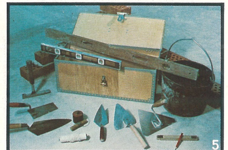
5) De vanligaste verktygen vid murningsarbete. Vid förflyttning mellan olika arbetsplatser förvaras verktygen i en lämplig låda. På byggsplatsen bärs oftast småverktygen i en bruksrulle (hink). Förekommande murningsverktyg är: vattenpass, kort och långt, måttstock och penna, vanlig murslev, "tysk" slev eller kakelslev, skärslev, murarlod med snöre, extra murarsnöre, "amerikansk" slev, iläggsslev, murarhammare.
