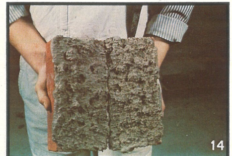
14) Efter några minuter bryts stenarna isär. Om man då har bruk kvar över båda tegeltyterna kan man räkna med god vidhäftning.
