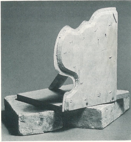
Profilmall (släde) för uppdragning av taklister i rum.
