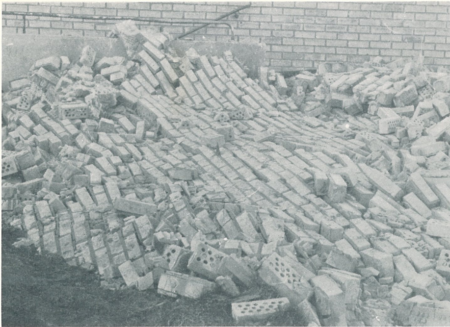
Fig. 7: Fall 2. Den nedfallna »tegelhögen» tyder på att väggen fallit i ett stort stycke, möjligen efter inledande småras.
