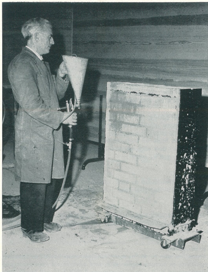
Fig. 4. Sprutning av provvägg på laboratoriet
