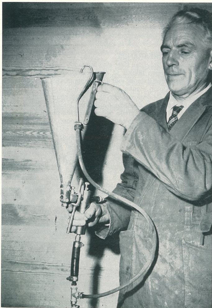
Fig. 3. JOA-spruta, använd vid laboratorieproven och försedd med tryckluftomröring
