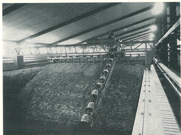
Grävmaskin med travers
