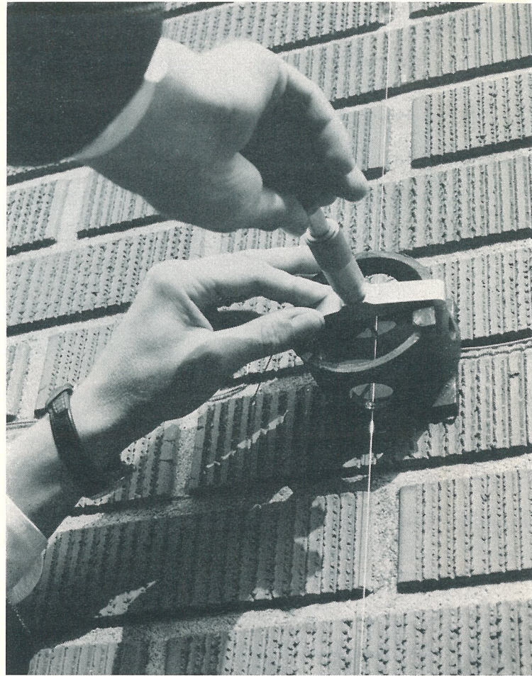
Foto 4: Mätning med djupmikrometer.
