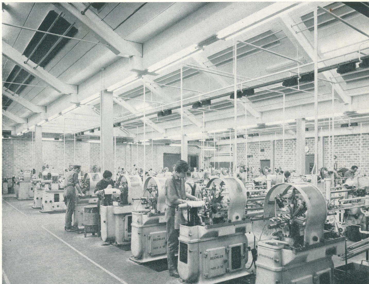
Interiör från verkstaden. Alla elinstallationer m. m. hänger i taket. Därigenom har man undvikit ingrepp i väggar och golv och man har fullständig frihet att planera om i lokalen.
