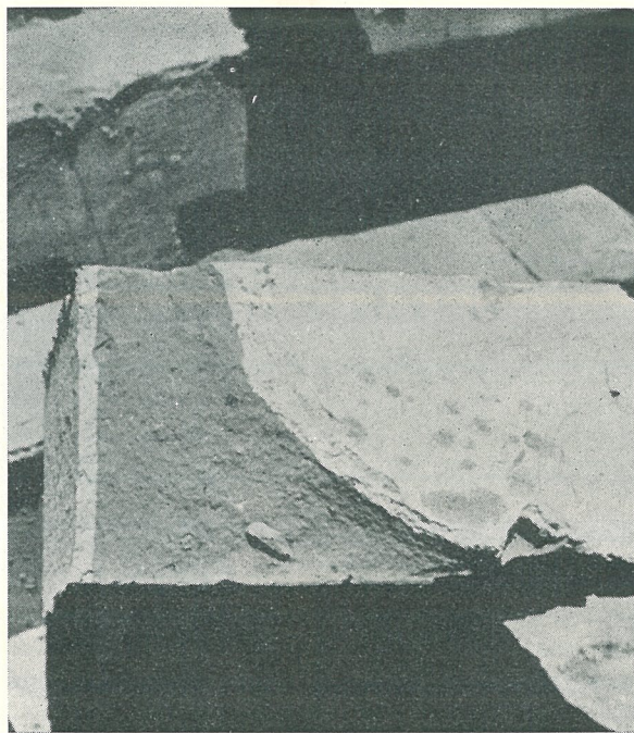
Bilden visar en tegelsten med röd kärna och gult ytskikt, tillverkad enligt metoden till vänster. Denna tegelsten har slagits sönder för att man skall kunna se att den gula leran endast utgör ett tunt skikt.
