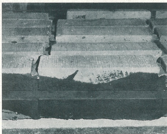
Färdiggjutna fasadskift klara att flyttas till lagret.
