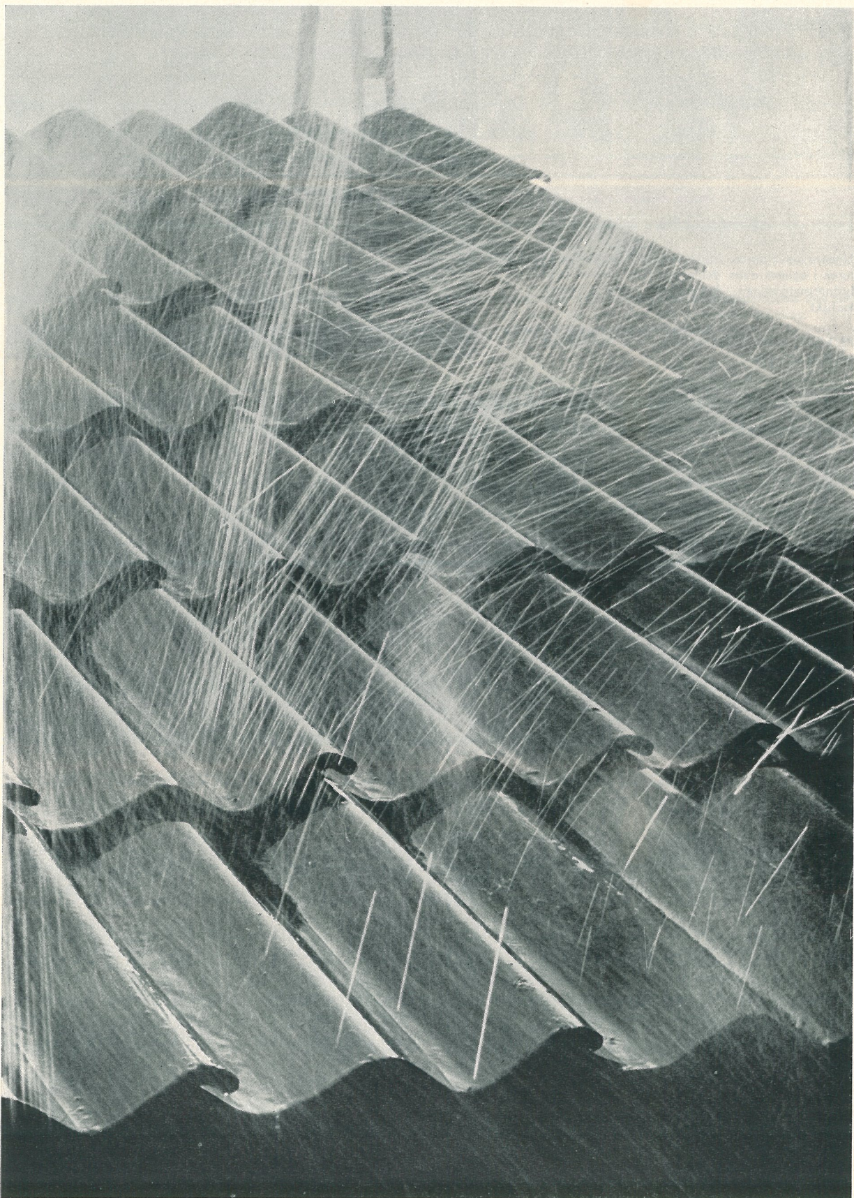
Tätheten hos tegeltak undersöks. På ett provtak sprutar man vatten samtidigt som en kraftig fläkt ger en ordentlig blåst. Läckaget genom taket vid olika taklutningar och olika vindstyrkor mäts.
