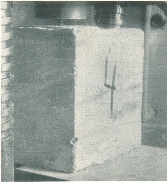
Fig. 12. Bilden är tagen strax före att kamstålet pressas nedåt genom fogen.
