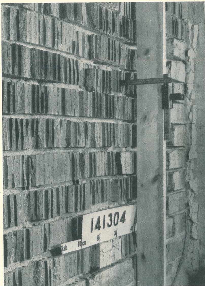
Närbild av murväggs eldsida efter 8-timmars brandprov och vattenbesprutning
