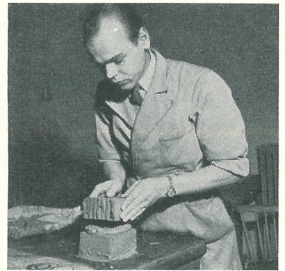
För hållfasthetsprov delas tegelstenen mitt itu och de två halvorna sammanfogas och avplanas med cementbruk
