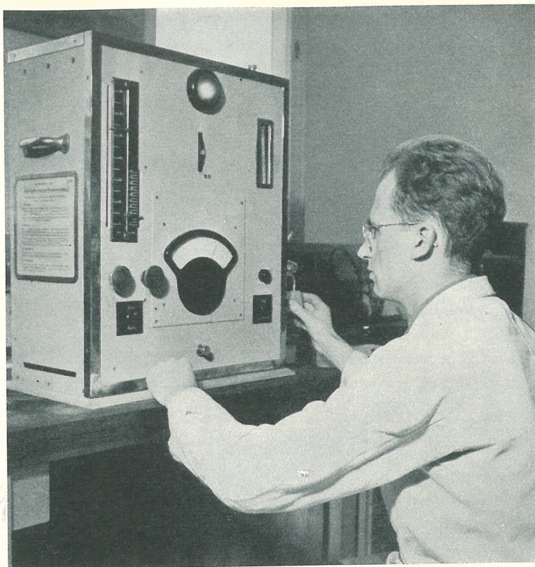
Assistent A. Eklind i arbete vid flamfotometern. Med denna bestämmes mycket snabbt lerors och tegels halt av vissa salter
