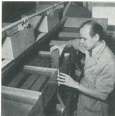
För att ett material skall kunna frysa sönder måste det vara vattennättat. Vid frostbeständighetsprovet vattenslägs därför först stenarna
