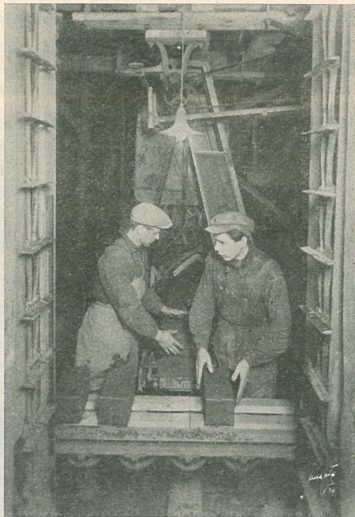
Fig. 2. Två man plockar ca 40 000 sten om dagen från skärbordet fram på automatiskt framförda lattor, eller på gamla höjelevatorn.
