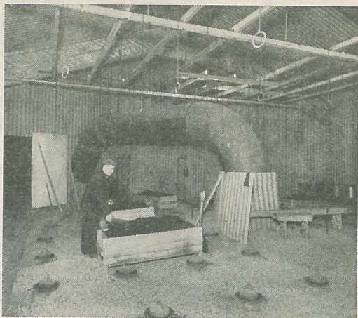
Fig. 11. Överföring av varmluft från ringugnen till kammartorkan.
