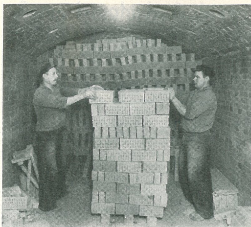
Fig. 15. Bränt tegel sorteras och staplas för trucken.
