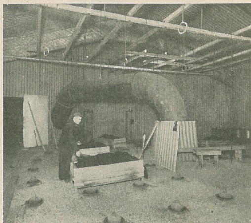
Fig. 11. Överföring av varmluft från ringugn till kammartorkan.
