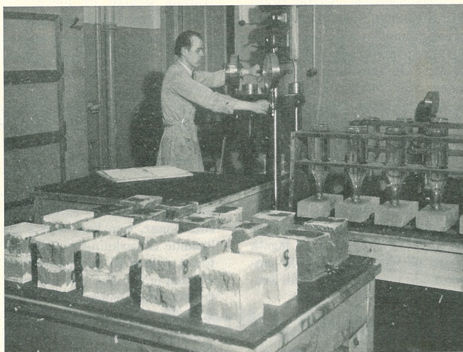
Bild 6. Tryckhållfastheten bestäms med laboratoriets 125-tons press. T. h. bestämning av benägenhet för utslag av lösliga salter.
