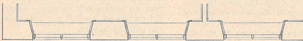
Fig. 4. Kryssförband med symmetriskt förband i pelare och fönsterbröstningar. Symmetriskt raka valv med upplag 1:4 = 8 cm och vågräta stötfogar. Lägg märke till förbandet vid fönstersmygarna.
