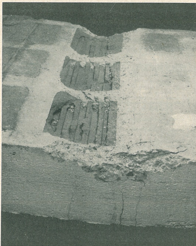
Fig. 9. Sekundärt tryckbrott vid böjprovning av bjälklagsplatta D I. Krossade delar av tryckzonen äro borttagna.
